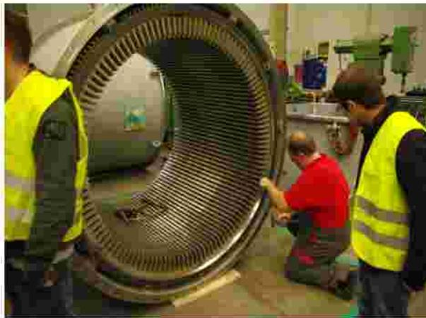
In einem weiteren Arbeitsschritt werden die Statorn gefertigt. Hier sehen wir einen Stator, der per Hand aus dünnen Blechen geschichtet wurde. In die Nuten werden anschließend von Hand die vorgefertigten Spulen in zwei Schichten eingelegt.
