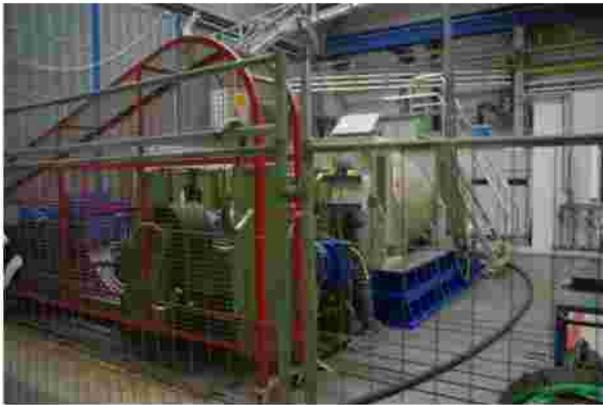
Nach der Zusammenführung von Stator und Rotor wird der Generator ins Prüffeld gebracht. Es werden hier u.a. elektrische Belastungstests durchgeführt.
