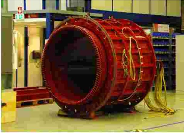
Weiter im Rundgang sahen wir einen fertig gewickelten Stator mit Schutzlackierung und nach außen geführte Anschlüssen für die einzelnen Stränge und die Temperaturüberwachung.
