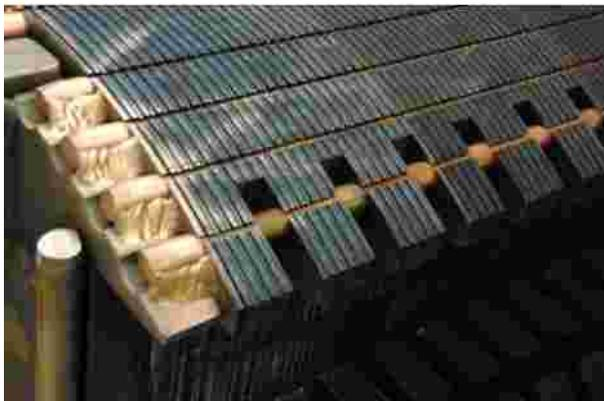
Bei der Rotorfertigung werden für die Käfigwicklung Kupferstäbe in die Läuferpole eingeschoben und verschweißt. Die Rotorspulen werden an großen Wickelmaschinen von einem Arbeiter auf die Läuferpole gewickelt.
